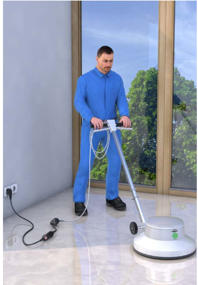
Abb. 70 Einscheibenmaschine mit PRCD-S
