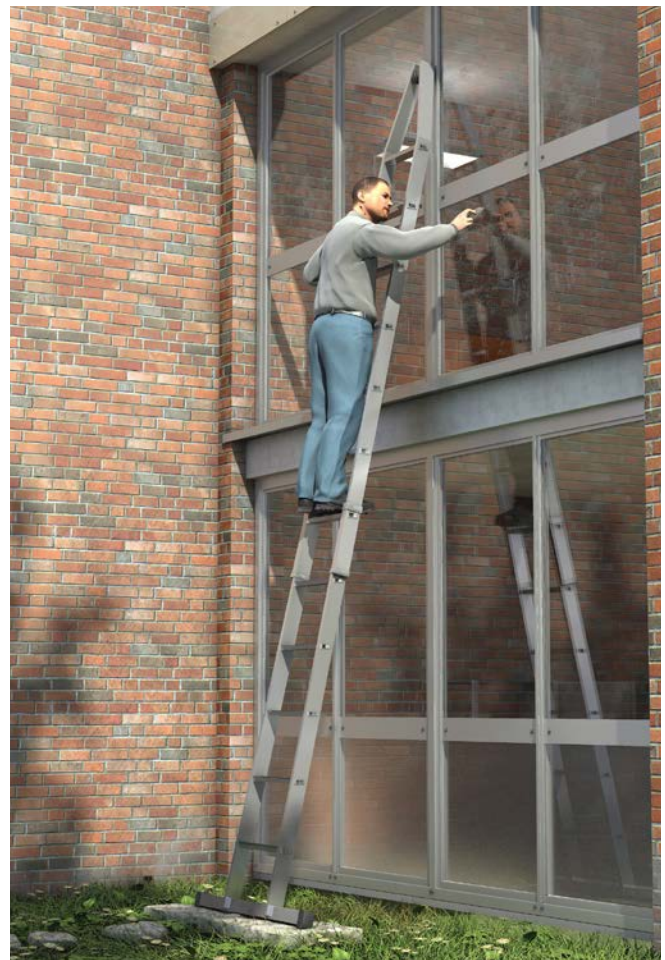
Abb. 46 Glasreinigerleiter mit Fußverbreiterung auf tragfähigen Untergrund
