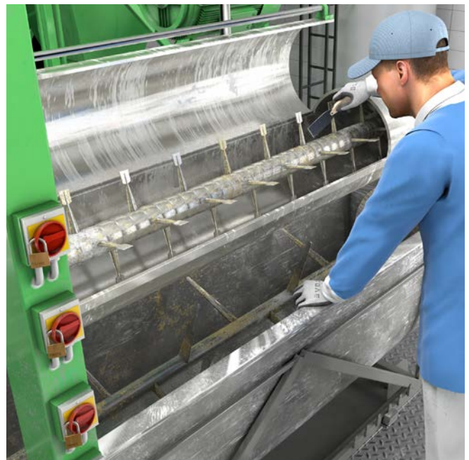
Abb. 73 Anlage gegen Einschalten gesichert
